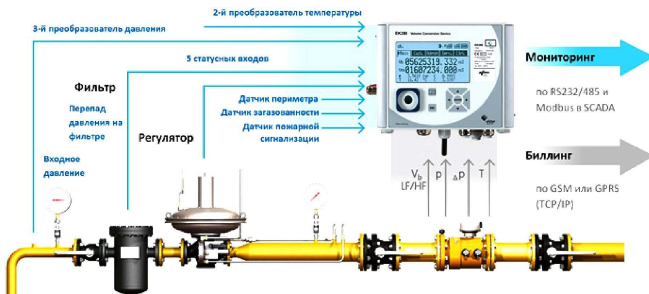
Рисунок 3 – Система контроля и управления на базе EK-280
