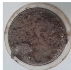
Рисунок 5 – Фильтрационная корка, сформированная после фильтрации буферной жидкости (0,5 % КМЦ и 15 % Al_2(SO_4)_3 ) через корку бурового раствора Boremax
