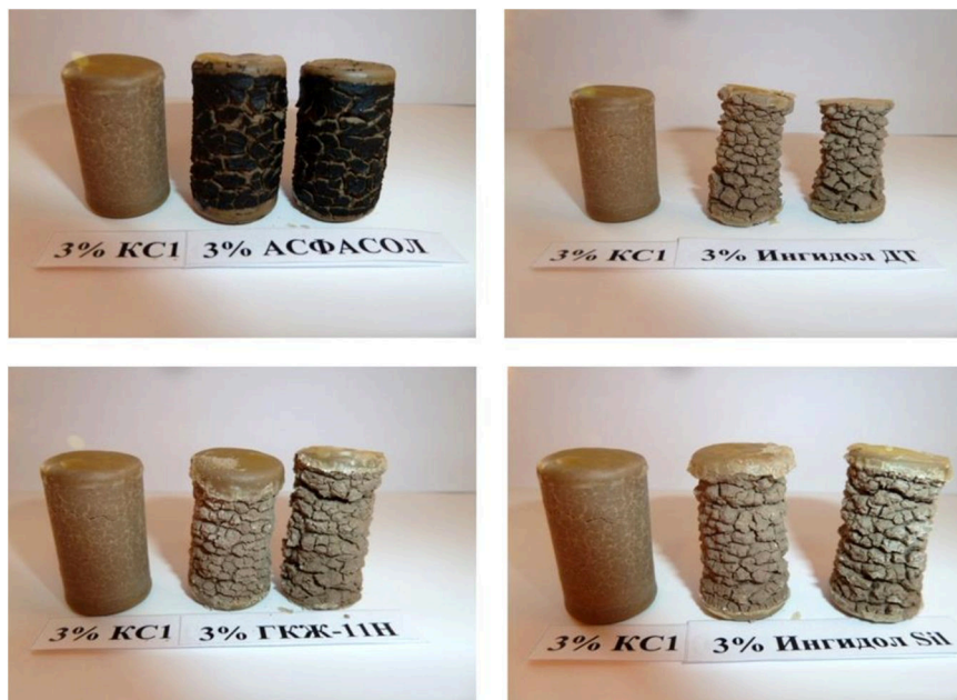
Фото глинистых эталонных столбиков после испытаний по РД 39-00147001-773-2004 ингибирующих свойств 3 %-ных растворов химреагентов сульфированного асфальта «Асфасол», «Ингидол ДТ», «ГКЖ 11 Н», «Ингидол SiI» и KCl
