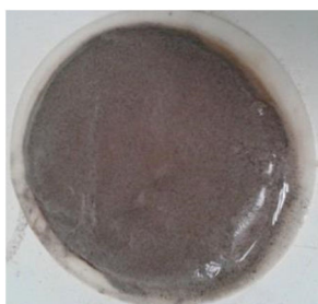
Рисунок 4 – Фильтрационная корка, сформированная после фильтрации буферной жидкости (0,5 % КМЦ и 15 % Al_2(SO_4)_3 ) через корку бурового раствора Poly Plus
