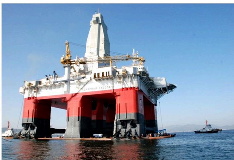
Рисунок 1 – ППБУ «Полярная звезда» (КМ(*) [1] AUT1-ICS EPP semi-submersible ice-resistant MODU) . Хорошо видны пары якорей на опорных колоннах
