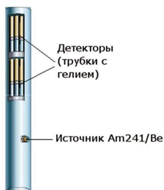
Рисунок 6 – Компоненты датчика пористости TNP
