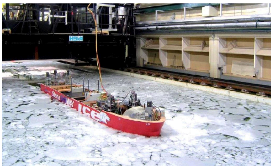
Рисунок 2 – Модель судна в ледовом бассейне [1]
