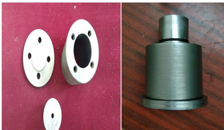
Рисунок 2 – Форма для формирования цементного камня под давлением
