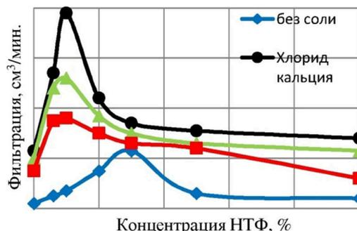
**Рисунок 7** – Зависимость фильтрации буферной жидкости от типа соли (10 %) и концентрации НТФ (Poly Plus)
