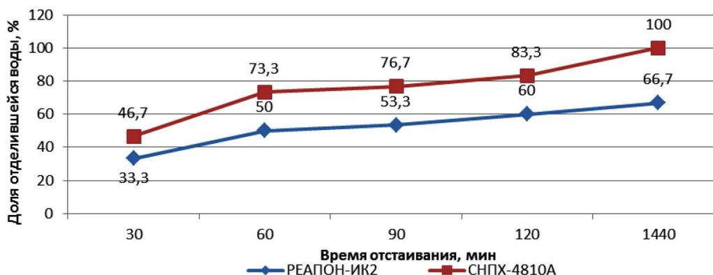
Рисунок 4 – Динамика отделения воды из образца эмульсии № 2 при наличии деэмульгаторов
