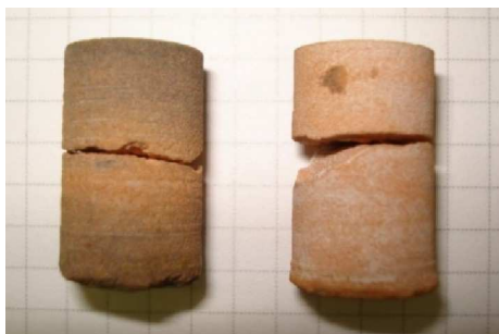
Рисунок 1 – Рабочий фрагмент образцов твердого кольматанта выделенных из структуры околоскважинной зоны после испытаний на изгиб
