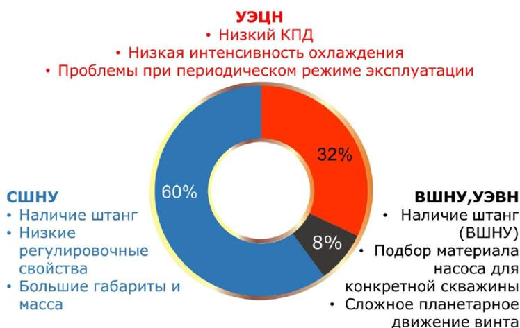
**Рисунок 1** – Распределение малодебитного фонда скважин по способам добычи
