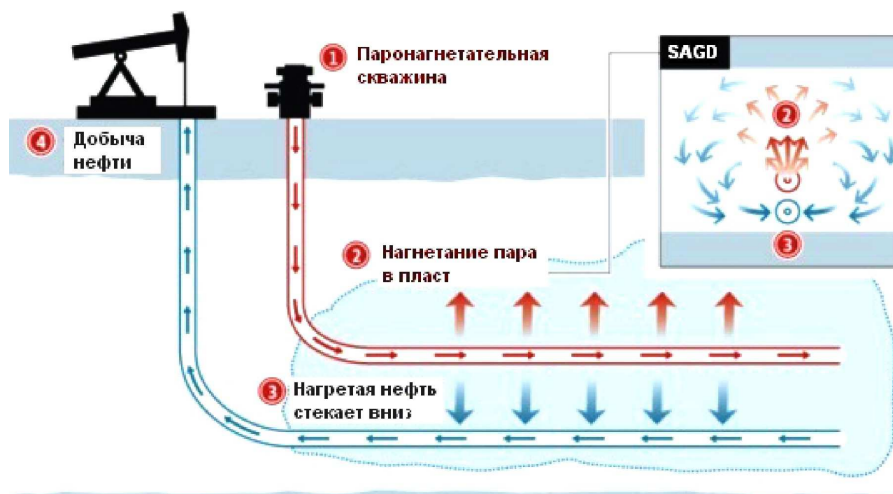
Рисунок 2 – Схема процесса гравитационного дренирования
