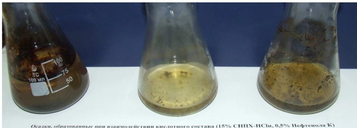
Рисунок 1 – Осадки, образованные в присутствии Нефтенола К
