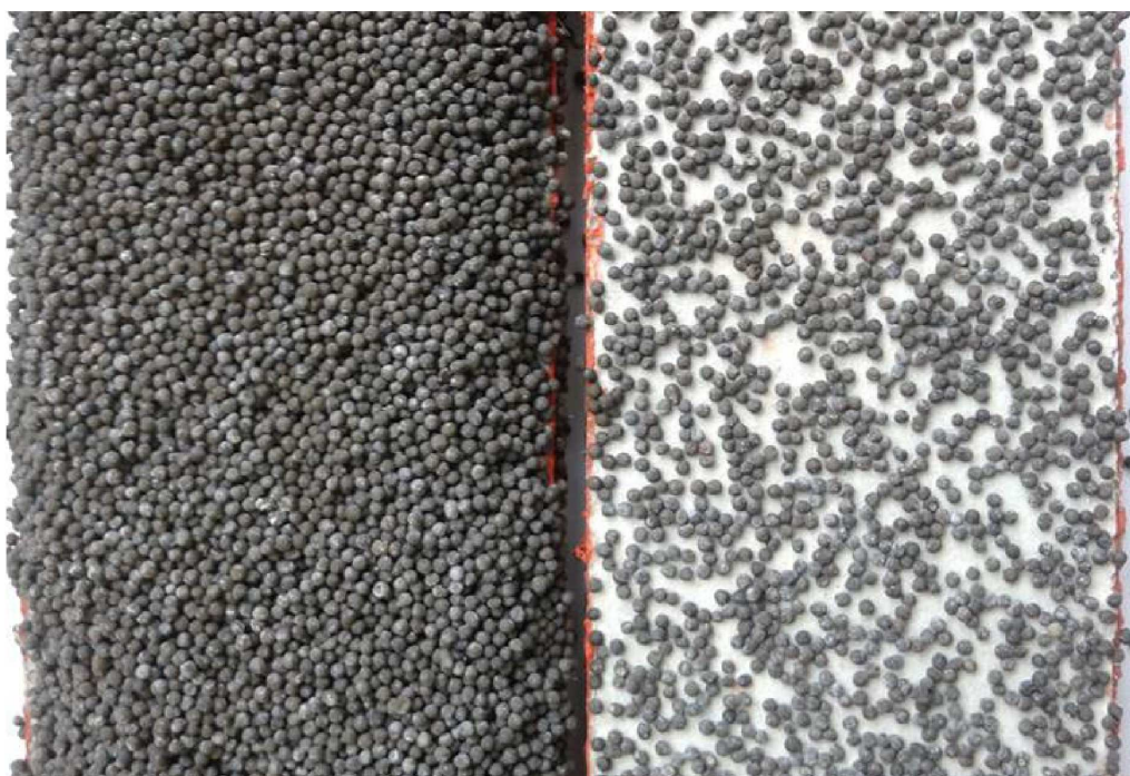
Рисунок 3 – Фотография керновых пластинок после проведения испытания с воздействием жидкости на углеводородной основе
