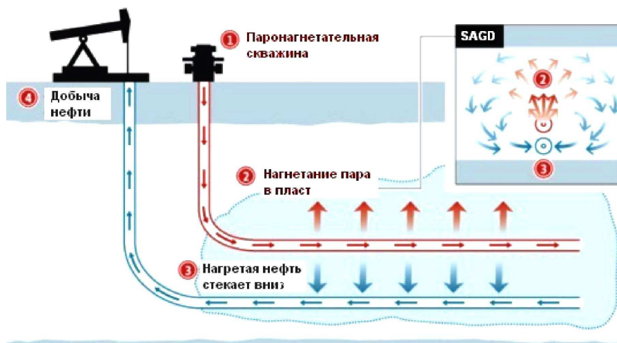
Рисунок 2 – Схема процесса гравитационного дренирования
