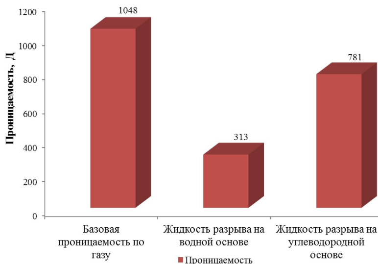
Рисунок 2 – Сравнение проницаемостей по газу до и после воздействия жидкостью разрыва на углеводородной и водной основе
