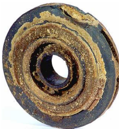
Рисунок – Отложения солей на рабочем колесе ЭЦН
