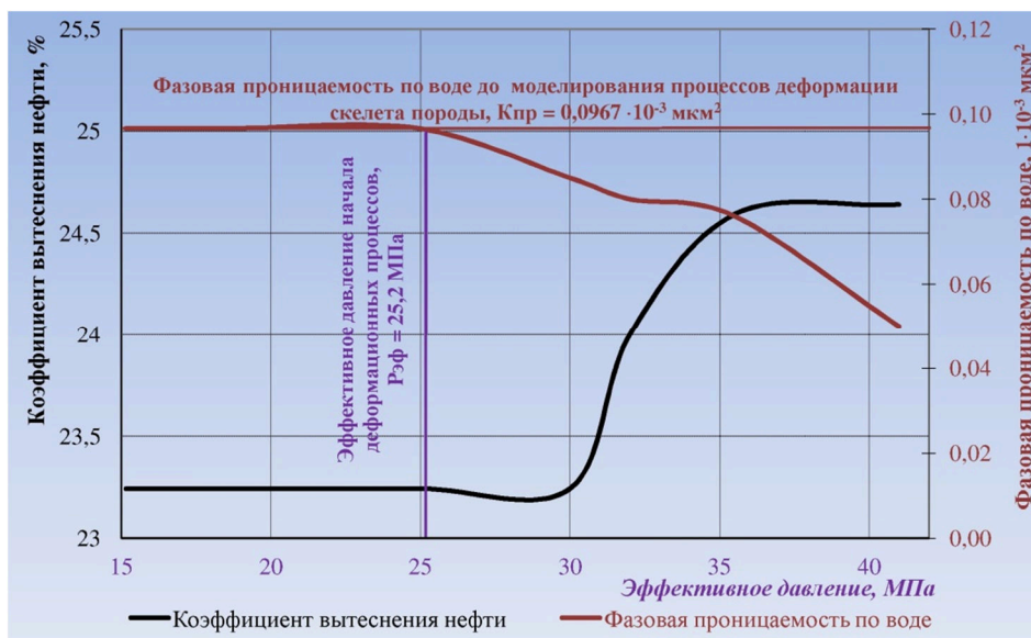
Рисунок 2 – Динамика коэффициента вытеснения нефти и фазовой проницаемости по воде на этапе снижения пластового давления в зависимости от эффективного давления (на примере Славянского месторождения, внутрисолевой (D3or) залежи)
