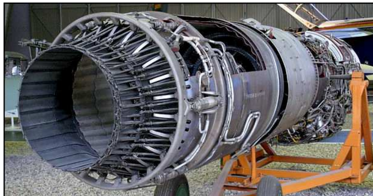
Рисунок 10 – Сопло Лавалья, регулируемое по оси, двигателя АЛ-21ф-3 самолета Су-24М
