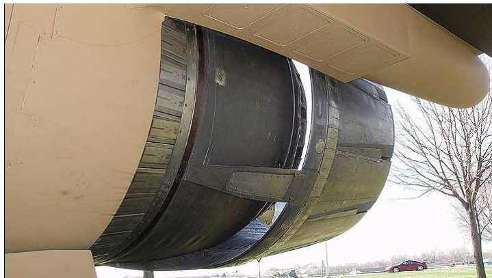
Рисунок 14 – Схема эжекторного сопла с прорезями двигателя TF-30-P самолета F-111
