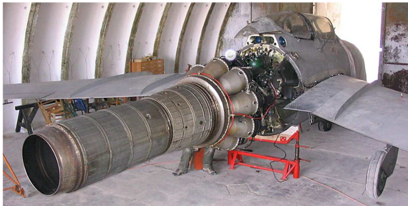
Рисунок 3 – Двигатель ВК-1 (самолет МиГ-15). Хорошо видно коническое сопло в конце удлинительной трубы
