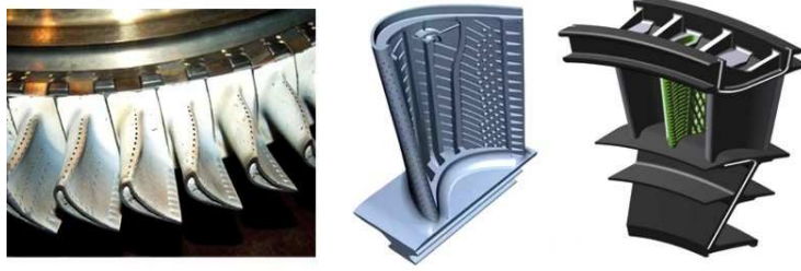
Рисунок 4 – Охлаждаемые лопатки авиационных ГТД
