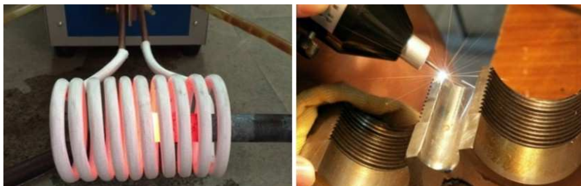
Рисунок 4 – Индукционная наплавка (а); электроискровая наплавка (б)
