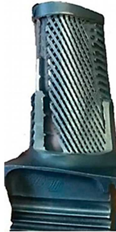
Рисунок 10 – Охлаждаемая лопатка с вихревой матрицей
