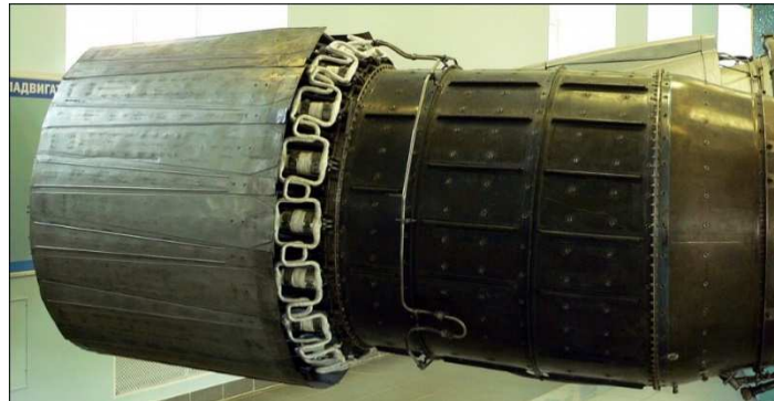
Рисунок 16 – Схема «сложного» эжекторного сопла двигателя Д30Ф-6 самолета МиГ-31
