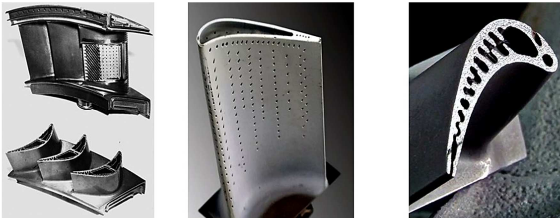
Рисунок 5 – Принципиальные схемы воздушного охлаждения лопаток
