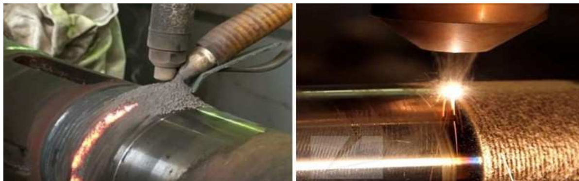
Рисунок 3 – Электрошлаковая наплавка (а); лазерная наплавка (б)
