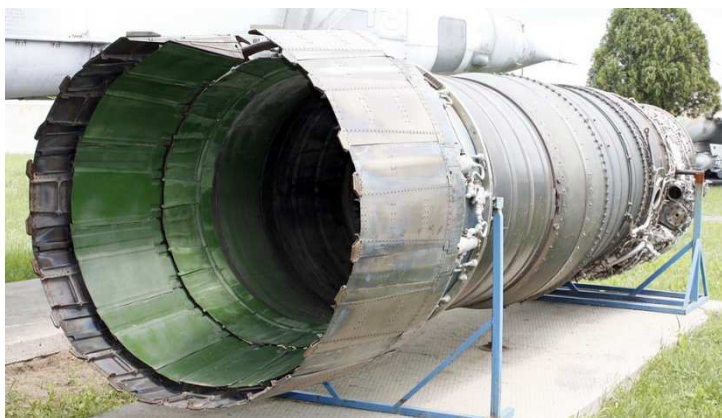
Рисунок 15 – Схема эжекторного сопла двигателя Р-15 БД-300 самолета МиГ-25
