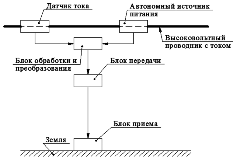
Рисунок 1 – Структурная схема реализации системы измерения тока высокого напряжения
