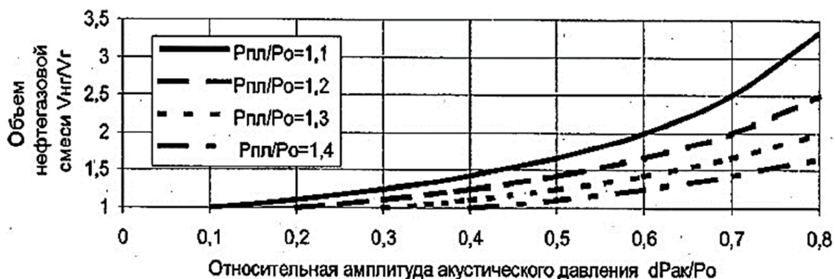
Рисунок 2 – Зависимость относительного объема нефтегазовой смеси V_{нг}/V_{г} от относительной амплитуды акустического давления dP_{ак}/P_0 при различных соотношениях P_{пл}/P_0
