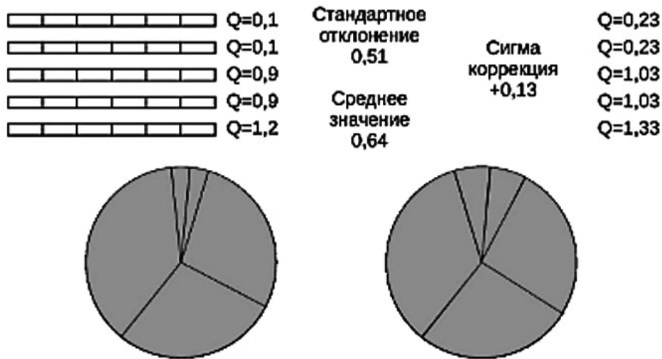
Рисунок 3 – Применение сигма коррекции фитнес-функции при селекции методом колеса рулетки
