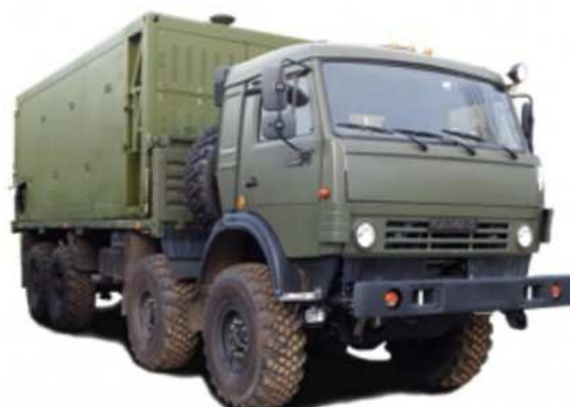
Рисунок 4 – Универсальный мобильный комплекс поверки и ремонта средств измерений
