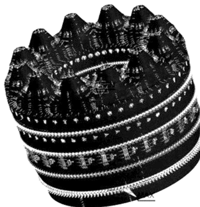
Рисунок 6 – Распределение температурных напряжений в корпусе ЖТ
