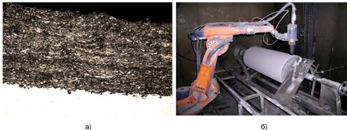
Рисунок 8 – Микроструктура плазменного покрытия (а); установка высокоскоростного сверхзвукового газопламенного напыления (б)
