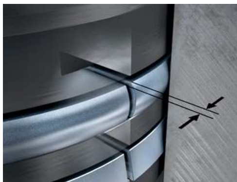
Рисунок 14 – Тепловой зазор в смонтированном состоянии
