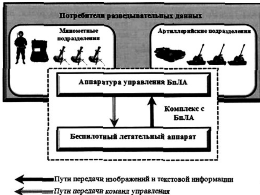
Рисунок 8 – Схема информационного взаимодействия БЛА и артиллерийской батареи
