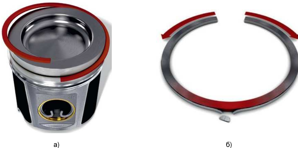
Рисунок 9 – (а) – Перекручивание и растягивание поршневых колец при установке на поршень, (б) – отслаивание покрытия в области спинки кольца
