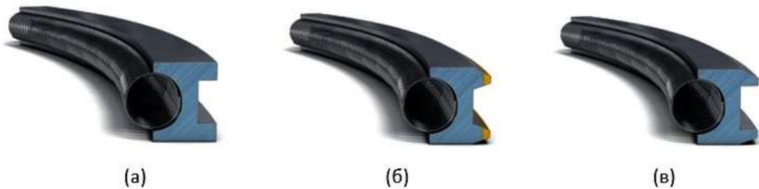
Рисунок 5 – (а) – Маслосъемное коробчатое кольцо с прорезями и пружинным расширителем, (б) – маслосъемное коробчатое кольцо со сходящимися фасками, пружинным расширителем и хромированными рабочими поясками, (в) – маслосъемное коробчатое кольцо со сходящимися фасками и пружинным расширителем, изготовленное из азотированной стали
