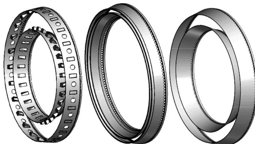
Рисунок 4 – Секции жаровой трубы – с четвертой по шестую
