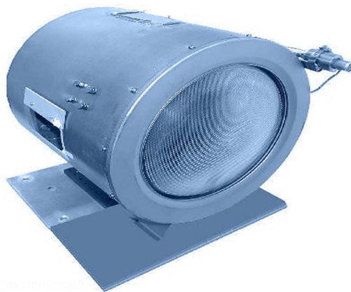
Рисунок 4 – Простейший ионный двигатель
