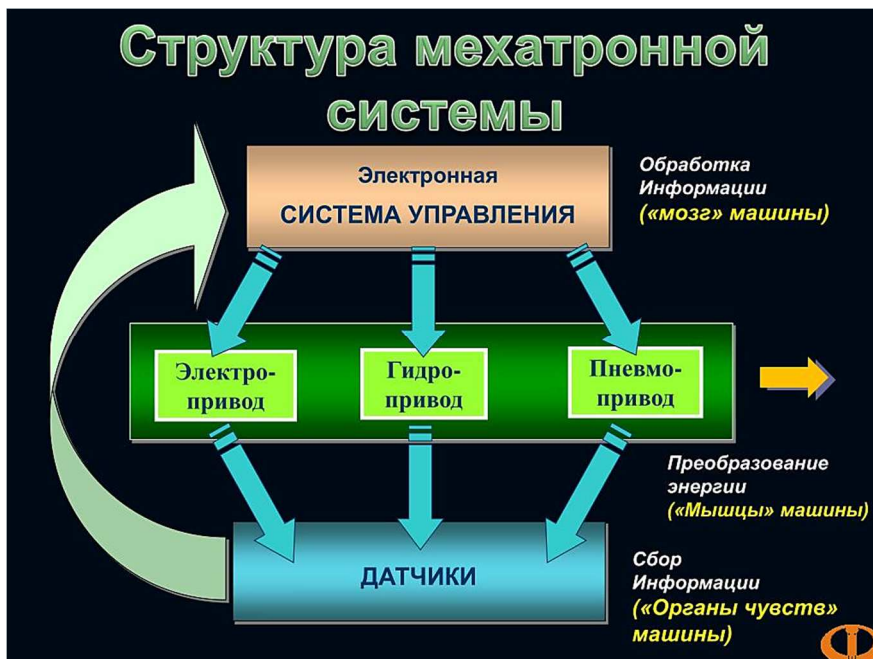
Рисунок 1 – Структура мехатронной системы
