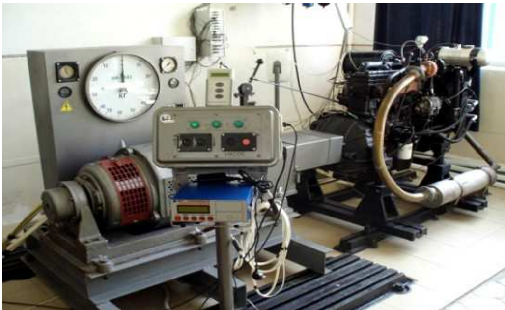
Рисунок 12 – Стенд натуральных испытаний деталей цилиндропоршневой группы
