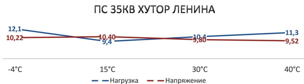
Рисунок 1 – Зависимость нагрузки и напряжения от температуры на ПС 35кВ Хутор Ленина
