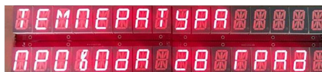
Рисунок 2 – Система отображения информации для автоматизированного комплекса плавки и мониторинга гололедообразований на ВЛЭП
