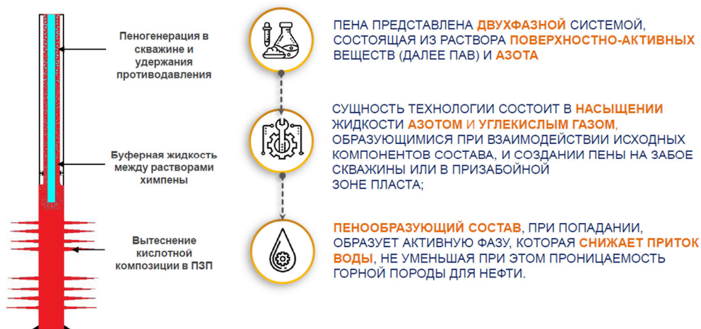
Рисунок 2 – Процесс воздействия пены на ПЗП
