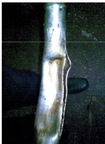
Рисунок 4 – Характер деформирования и разрушения труб датчиков давления и температуры
