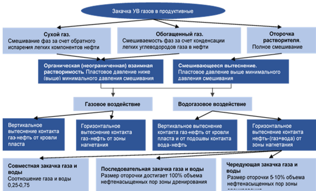
Рисунок 2 – Варианты закачки газа в пласт
