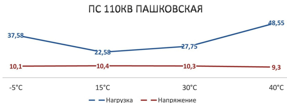
Рисунок 2 – Зависимость нагрузки и напряжения от температуры на ПС 110кВ Пашковская
