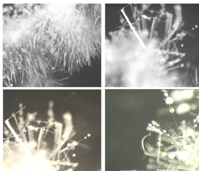
Рисунок 2 – Кластеры из наноструктур оксида цинка под оптическим микроскопом
