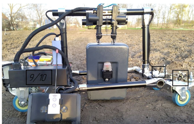
Рисунок 5 – Внешний вид автономного устройства для определения места повреждения кабеля и расположение некоторых его узлов
