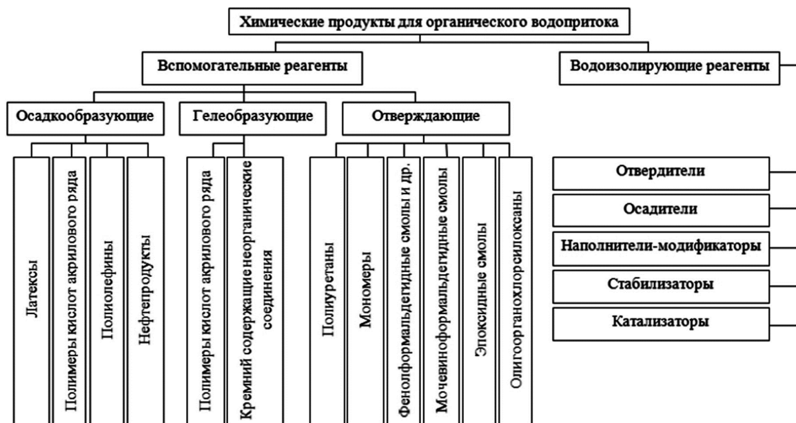
Рисунок 1 – Схема классификации химических реагентов для ограничения водопритока
