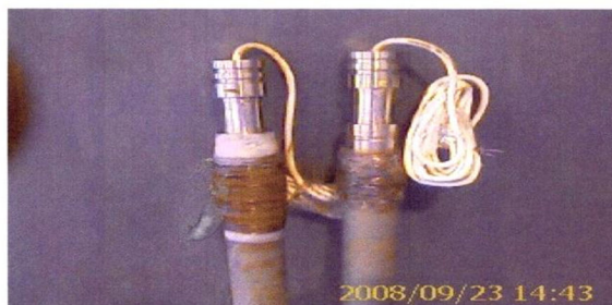
Рисунок 3 – Внешний вид конструкции скважинного термоизлучателя типа ТГС «БУР»
