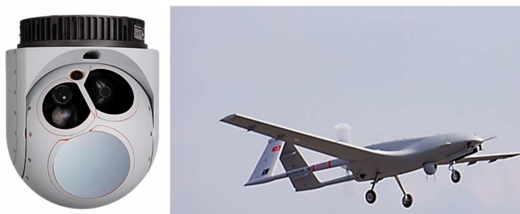
Рисунок 2 – «Bayraktar TB2» с установленной системой CMX 15D
