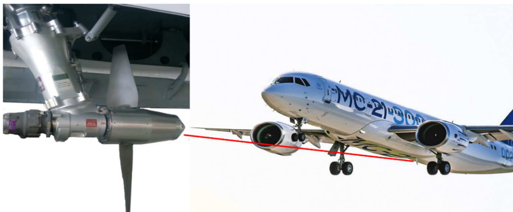
Рисунок 5 – АВЭК с гидронасосом и электрогенератором на самолёте MC-21
