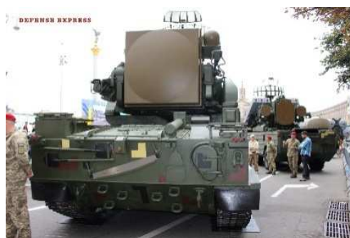
«Тор» Экипаж, 4 чел. Масса БМ, 32 т. Дальность поражения, 12 км. Высота поражения, 10 км.
