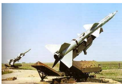
«С-75» Минимальная дальность поражения целей: 7 км Максимальная дальность поражения целей: 29–45 км Высота поражения целей: 27 км Количество целевых каналов: 1
