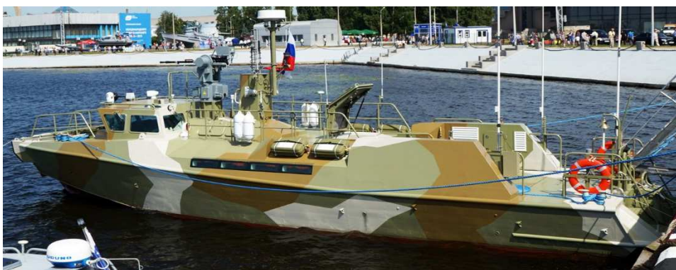
Рисунок 3 – Дистанционно управляемый боевой модуль «УПРАВА-КОРД», установленный на патрульном катере
