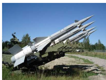
«С-125» Дальность поражения целей: до 22 км Высота поражения целей, 14 км Количество целевых каналов: 1
