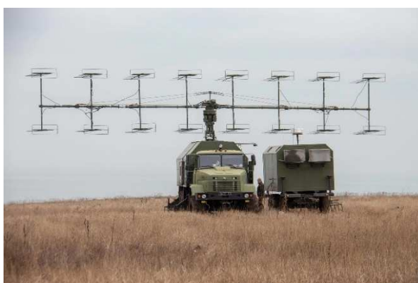
Рисунок 9 – Радиолокационная станция П-18
