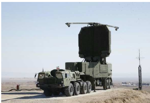
Рисунок 8 – Радиолокатор обнаружения 64Н6
