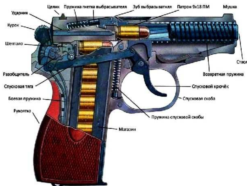
Рисунок 3 – Основные части и механизмы 9-мм пистолета Макарова
