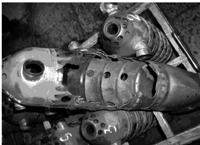
Рисунок 1 – Прогар жаровой трубы
