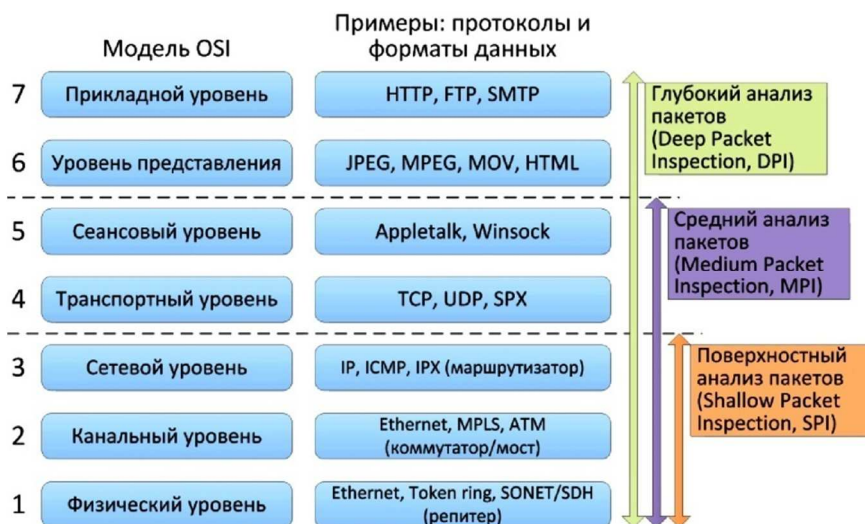
Рисунок 2 – Уровни анализа сетевого трафика по «глубине»
