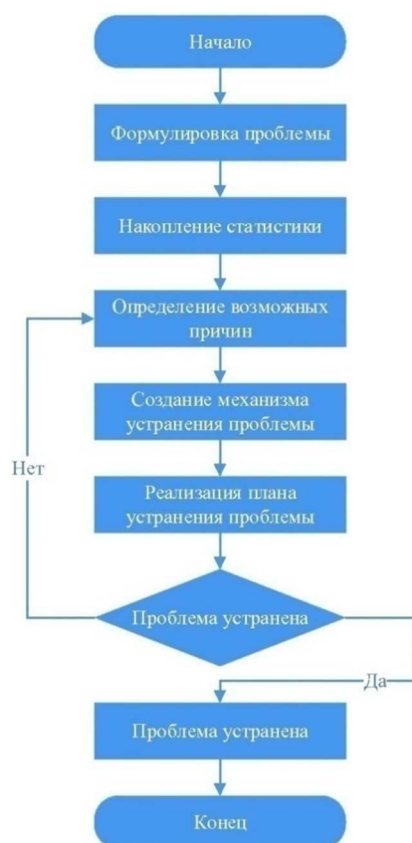
Рисунок 1 – Блок-схема общего алгоритма поиска неисправности
