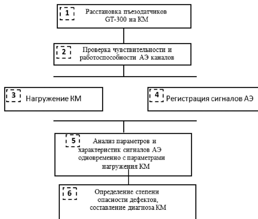
Рисунок 4 – Методика проведения АЭ контроля КМ
