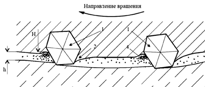
Рисунок 1 – Схема обработки заготовки вращающимся алмазным роликом: 1 – алмазы; 2 – связка; 3 – обрабатываемый материал; 4 – срезанные частицы обрабатываемого материала; h – зазор; H – высота выступания алмазов из связки
