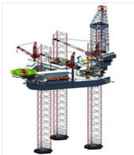
Рисунок 1 – СПБУ с опорами и башмаком у основания
