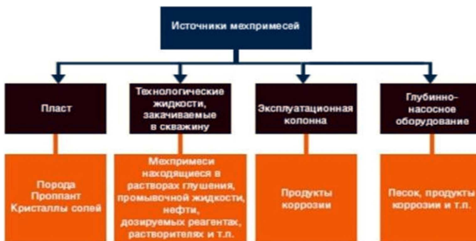
Рисунок 2 – Источники механических примесей, попадающих в насосную установку
