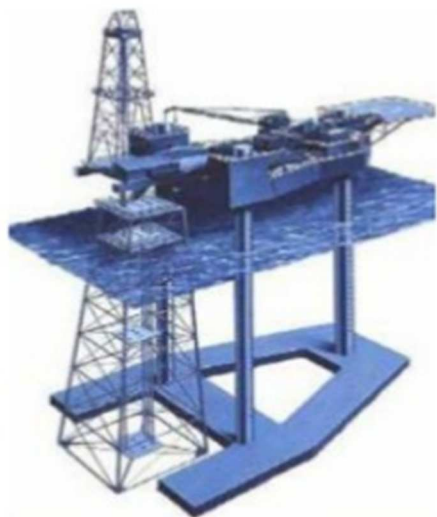
Рисунок 3 – СПБУ с опорной плитой у основания
