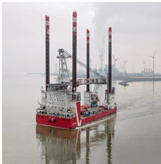
Рисунок 2 – СПБУ с цилиндрическими опорами
