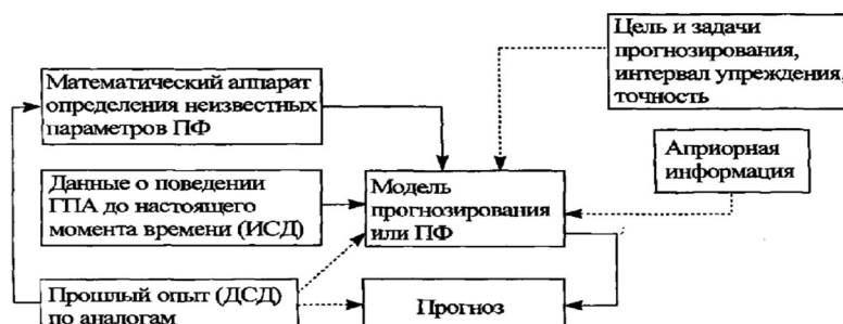
Рисунок 1 – Схема прогнозирования изменения технического состояния ГПА [1, 5]
