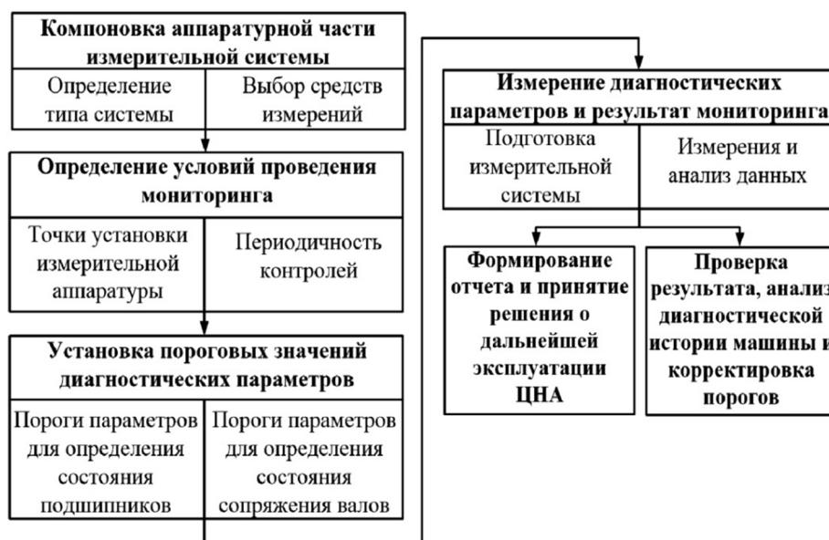
Рисунок 1 – Порядок реализации методики контроля по спектрам тока и напряжения
