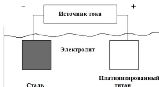
Рисунок 3 – Схема защиты наложенным током
