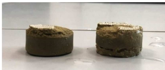
Рисунок 6 – Глинопесчаные образцы после 2-х часов в полимерном растворе с добавлением солей калия и натрия
