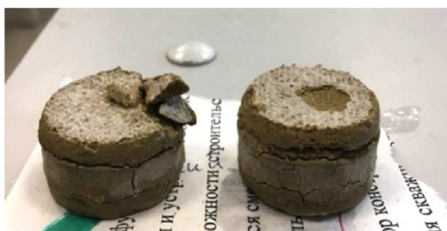
Рисунок 4 – Глинопесчаные образцы после 2-х часов в полимер-калиевом буровом растворе
