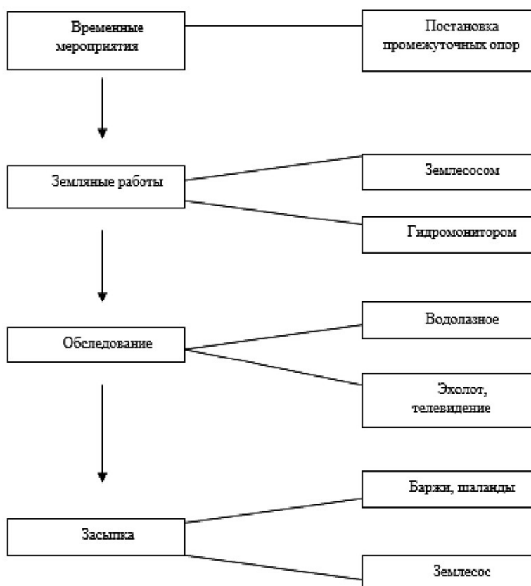
Схема 1 – Схемзаглубления провисающего участка трубопровода
