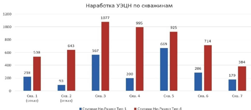
Рисунок 1 – Рост средней наработки на отказ за счет внедрения насосов компрессионной сборки с рабочими органами из высоколегированного чугуна НиРезист Тип 4 (стандарт ASTM A436)
