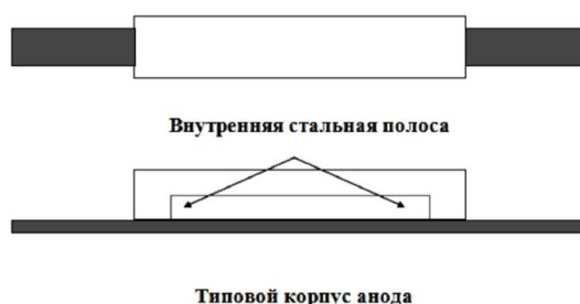
Рисунок 2 – Способ крепления катода
