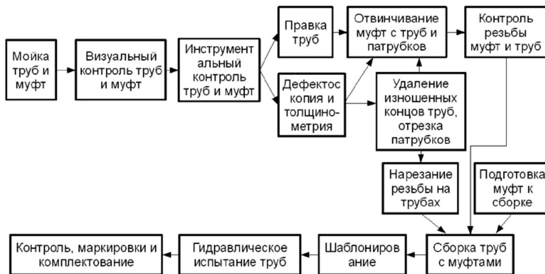
Рисунок 1 – Технологическая схема ремонта НКТ
