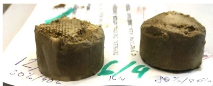
Рисунок 5 – Глинопесчаные образцы после 2-х часов в утяжеленном глинистом растворе
