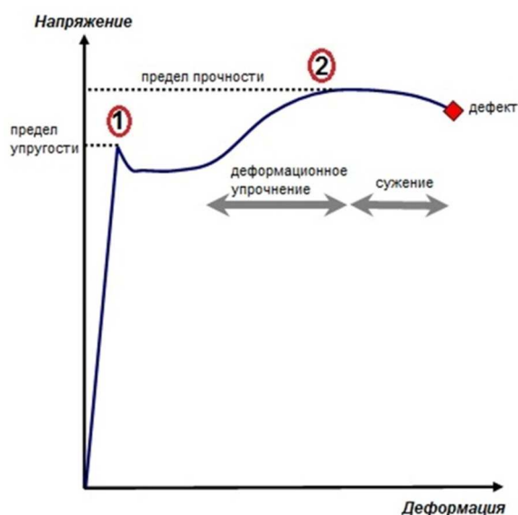
Рисунок 1 – Кривая напряжения-деформации: точка 1 – предел текучести; точка 2 – предел прочности при растяжении
