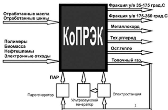
Рисунок 4 – Копроцессинг парового и резинового электромагнитного крекинга – КоПРЭК или (Со-ПРЭК)
