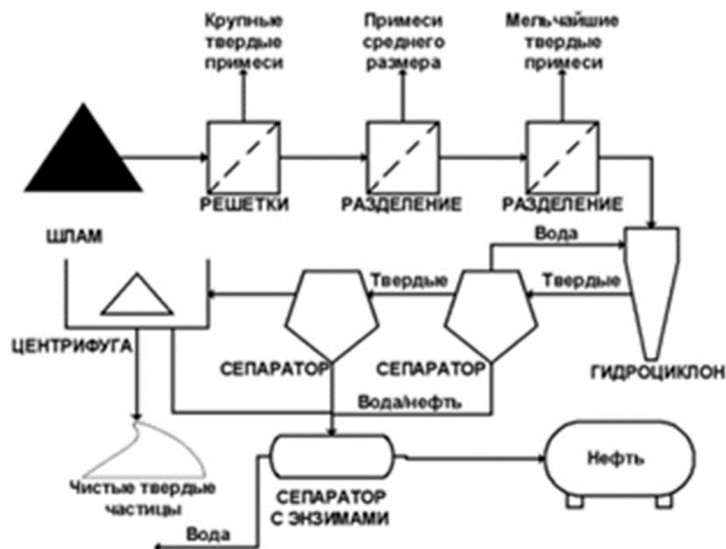
Рисунок 3 – Схема переработки шламов с использованием ферментов (ферменты)
