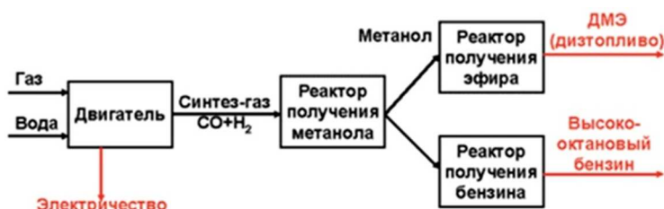
Рисунок 1 – Схема переработки попутного нефтяного газа
