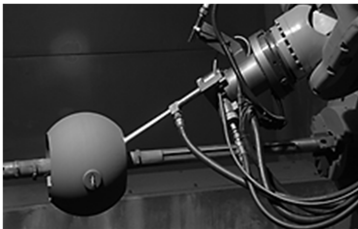
Рисунок 1 – Процесс электродугового напыления детали
