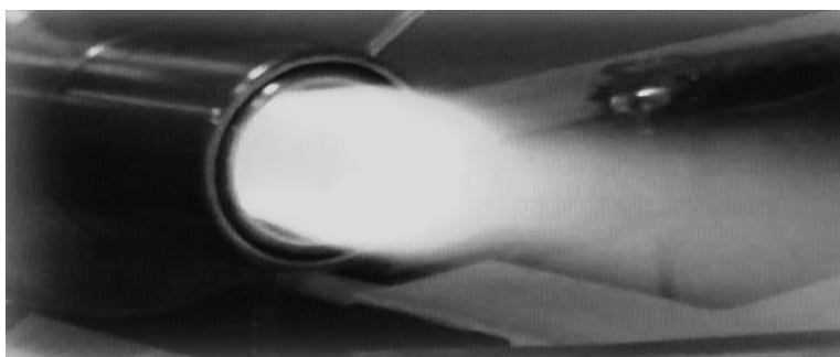
Рисунок 3 – Вид факела при работе предкамеры без использования внешнего завихрителя
