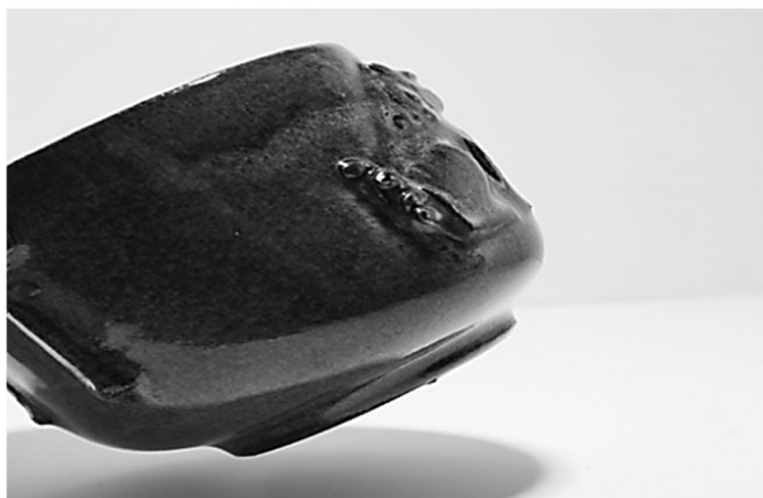
Рисунок 7 – Тесонит после обжига и отвердевания
