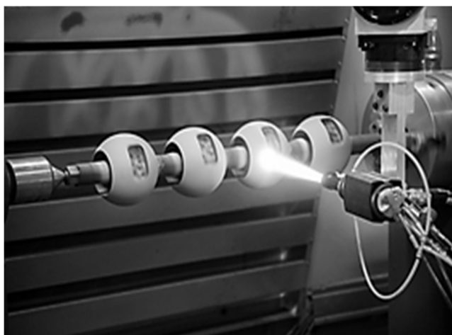
Рисунок 2– Процесс газоплазменного напыления детали
