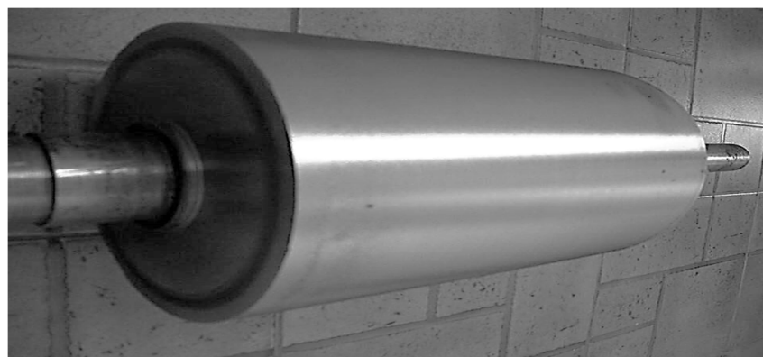
Рисунок 5 – Внешний вид вальца, после обработки покрытий точением
