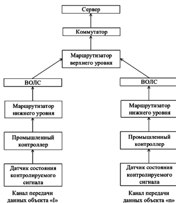
Рисунок 1 – Структурная схема системы с автоматическим способом формирования информации на объектах и автоматической передачей ее с объектов непосредственно на сервер.
